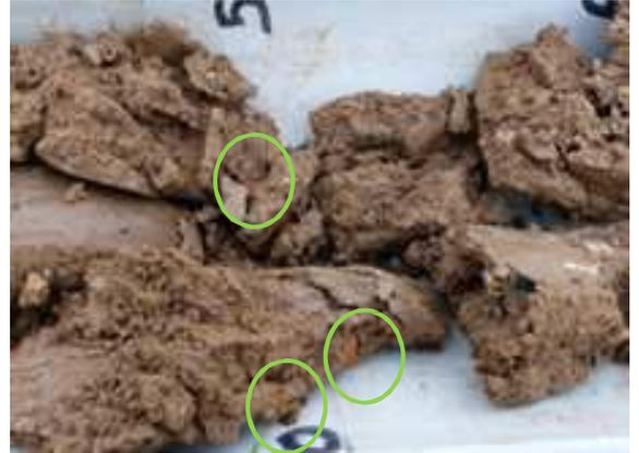
ATTENTION : Ne pas confondre taches d'oxydation et morceaux de tuiles ou de briques comme ceux entourés sur la photo !
